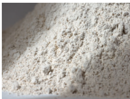
Полевой шпат, основной компонент фритты
